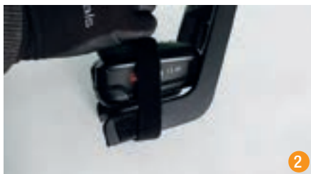
2. Serrare la base del trapano con la cinghia
