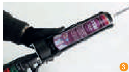
3. Inserire la cartuccia nell'adattatore
