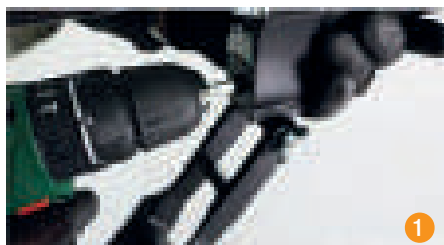
1. Inserire il trapano nell'ugello esagonale e serrare il mandrino
