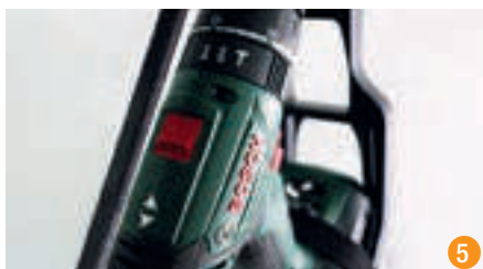
5. Regolare la velocità del trapano su 1
