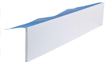
Spalletta prefinita LAI-SYS per l'isolamento della spalletta nell'imbotte della finestra. Trattasi di un EPS bianco già rasato con finitura cementizia e parasigolo già integrato.
