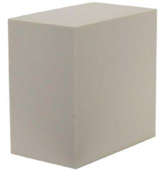
Blocco di montaggio in poliuretano giallo per il fissaggio di carichi pesanti nei sistemi ETICS. Una volta incollato il blocco sulla muratura con collante cementizio, va trapassato con viti lunghe a muro. Resiste allo schiacciamento e presenza il cappotto. Certificazione dei valori di compressione e di trasmittanza.
