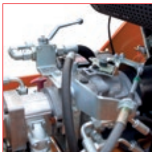
Sistema per disabilitare il tamburo posteriore Rear drum vibration can be disabled
