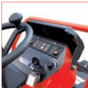
Coperchio antivandalo sistema di controllo Vandal proof cover for the control board
