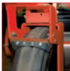
Raschietto per pulizia ruota timone Scraper for steering wheel
