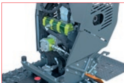
Sistema idraulico - pompa a 3 stadi Hydraulic system - 3-stage pump
