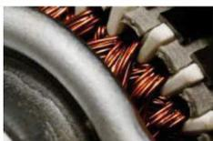
Alternatori 100% in rame a bassa resistenza e acciaio speciale forniscono una trasformazione ottimale dell'energia con perdite minime
