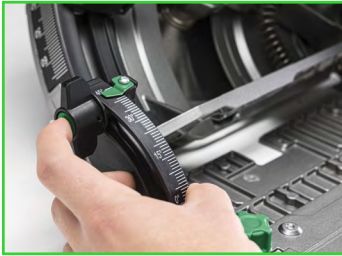
Doppia regolazione dell'inclinazione (da -1° a 46°), accuratezza e precisione al top.
