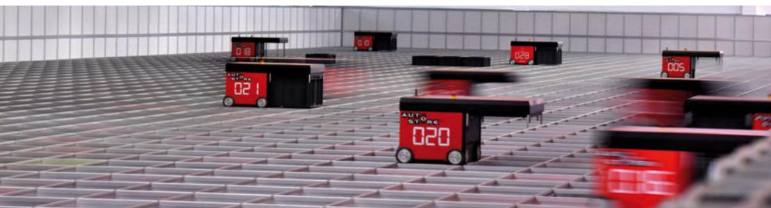
**41 robot**, in maniera totalmente automatizzata, prelevano gli articoli necessari a comporre ciascun ordine.
