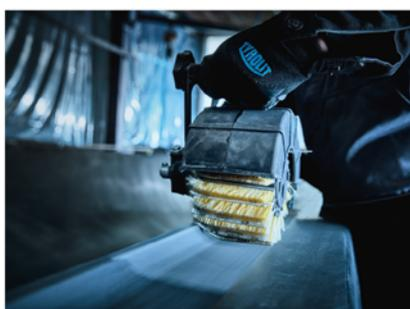
**Tyrolit Power** ha rivoluzionato la rifinitura delle superfici dure. Le strisce di levigatura costituite da strati di cactus e di diamante forniscono un'estrema durezza, fanno risparmiare tempo e riducono notevolmente le vibrazioni per l'utente.
