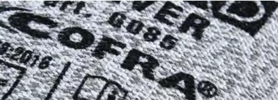
Filato di ultima generazione messo a punto da COFRA, privo di fibre di vetro. Garantisce una buona flessibilità ed elevate prestazioni meccaniche. Il suo diametro sottile si presta molto bene all'intreccio con altri filati permettendo di ottenere fodere altamente resistenti, senza comprometterne flessibilità e morbidezza.
