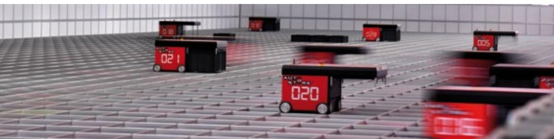
**33 robot**, in maniera totalmente automatizzata, prelevano gli articoli necessari a comporre ciascun ordine.
