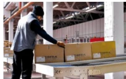
**Peso e volume vengono verificati** per controllare la conformità rispetto ai dati teorici e riportati sulla etichetta. In caso di difformità, il cartone viene scartato e ricontrollato.
