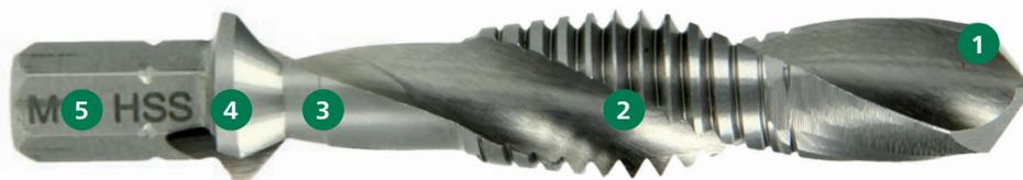
Le punte maschio svasatore in HSS-G sono progettate per forare, filettare e svasare in un'unica operazione, offrendo massima efficienza e precisione. Sono indicate per saltuarie attività di maschiatura e grazie alla loro progettazione 3-in-1, rappresentano una soluzione versatile e pratica, ideale per la lavorazione di lamiere e profilati in metallo.
