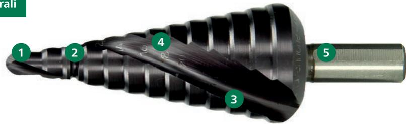
Le frese a gradino HiKOKI sono appositamente progettate per eseguire con rapidità fori dal diametro importante su tubi e lamiere sottili e sono adatte a forare materiali plastici, poliestere, acciaio ed acciaio inossidabile. Il diametro di foratura di ogni gradino è marchiato a laser nella spirale, in modo da rimanere sempre visibile anche dopo un utilizzo prolungato. Il gambo con tre fresature laterali assicura una presa ottimale
