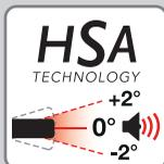
Lo strumento è dotato di **HSA Technology** (Horizontal - Sound - Assistant) un sistema di allerta automatico (beep continui ripetitivi ad alta frequenza) che entrano in funzione quando lo strumento si trova in posizione orizzontale ( $\pm 2^\circ$ ) sia in fase di puntamento, sia in modalità di misura.
