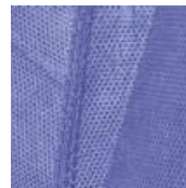
cuciture termosaldate a ultrasuoni
