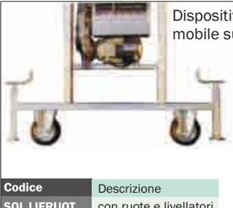
Dispositivo d'appoggio a terra mobile su ruote provvisto di n° 2 stabilizzatori e livellatori a vite consente di effettuare lo spostamento laterale della struttura e di compensare piccoli dislivelli
