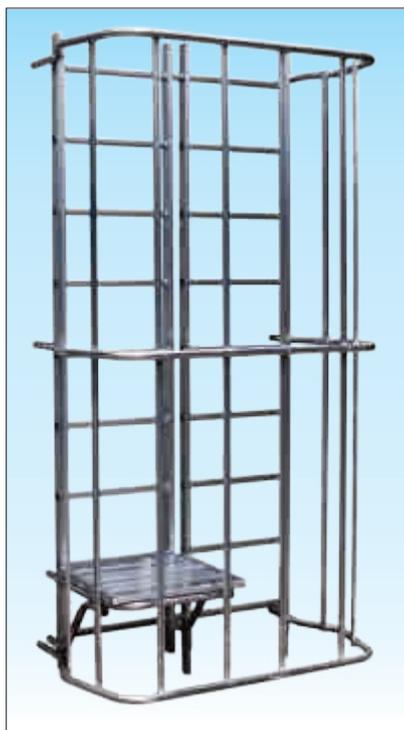
**N.B.** In accordo alle normative vigenti ogni massimo 10 metri è obbligatorio interrompere la salita utilizzando un piano di riposo ribaltabile art. SCA 4047 PR / SCA 4047 PRS oppure un modulo di sdoppiamento tonchi art. SCA 4047 MRP / SCA 4047 MRPE
