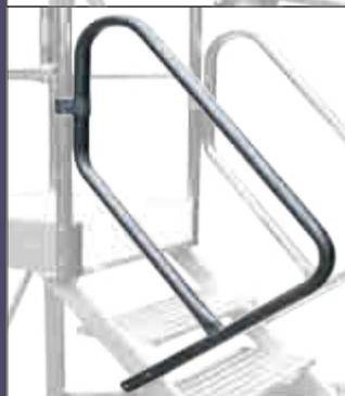
**Parapetto frontale e parapetto laterale** dotati di mancorrente alto mt. 1,10 e corrente intermedio realizzati in robusto profilo tondo Ø 42 mm. e provvisti di fermapiEDE alto 150 mm. in conformità a norme europee EN131
