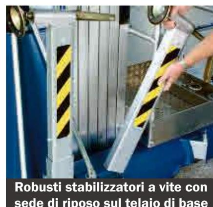
**Robusti stabilizzatori a vite con sede di riposo sul telaio di base**
