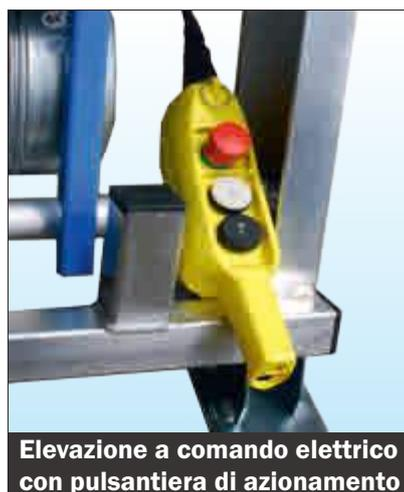
Elevazione a comando elettrico con pulsantiera di azionamento
