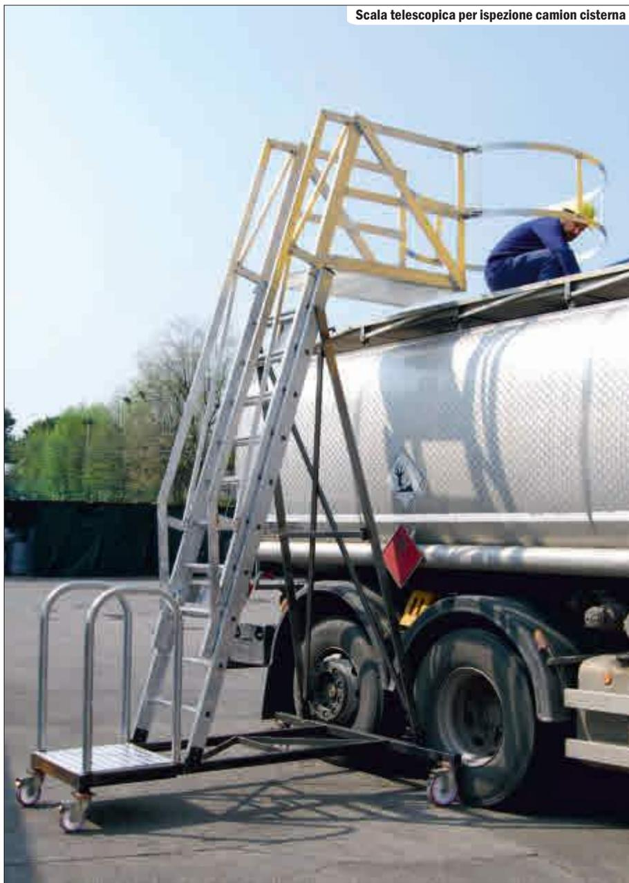
Scala telescopica per ispezione camion cisterna
