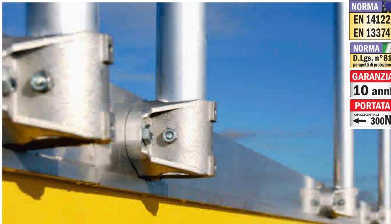
Disponibili in versione dritta e inclinata, vengono fissati alla struttura con tasselli meccanici dimensionati appositamente o con barre filettate resina chimica bi-componente. Possono essere installati sia all'interno che all'esterno della parete verticale, oppure sotto copertina o veletta, mediante gli appositi elementi di fissaggio.
