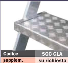
Gradino profondo 200mm realizzato in lamiera mandorlata che garantisce gradini molto robusti con spessore 3mm ed un anti-scivolo alto 2mm particolarmente efficace
