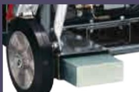
Kit zavorre per il telaio base
