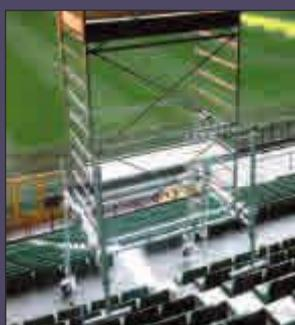
**Base GIGANTE con grande capacità di regolazione.** Realizzata in acciaio zincato tralicciata, regolabile in larghezza e provvista di n°4 grandi livellatori regolabili in altezza capaci di compensare dislivelli fino a mt. 1,5. e di n°4 stabilizzatori a vite. Ideata per un utilizzo su gradinate stadi o su poltrone cinema multisala.
