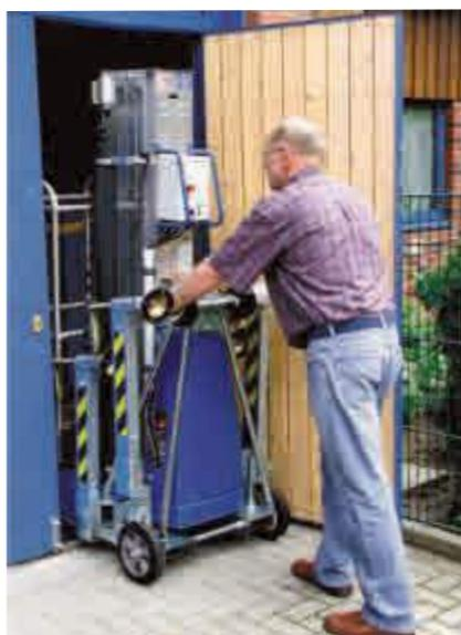
Leggera e compatta può essere trasportata anche su piccoli automezzi, dispone di grandi ruote a terra con freno di stazionamento e di ruote di scorrimento che permettono di sdraiare la macchina per il trasporto.
