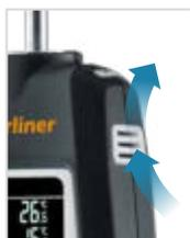
**Igrometro elettronico per localizzare e valutare la diffusione dell'umidità e i danni prodotti dall'umidità in pareti, pavimenti e soffitti**
