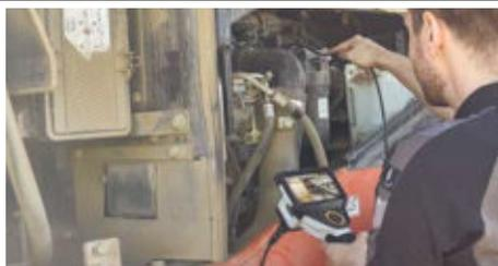
**Sistema professionale di videoispezione ad alta risoluzione con visualizzazione frontale e laterale**
